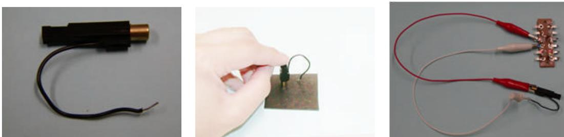
(a) 圧電点火素子      (b) 放電(電気火花)の確認      (c) 発光ダイオードでは?
